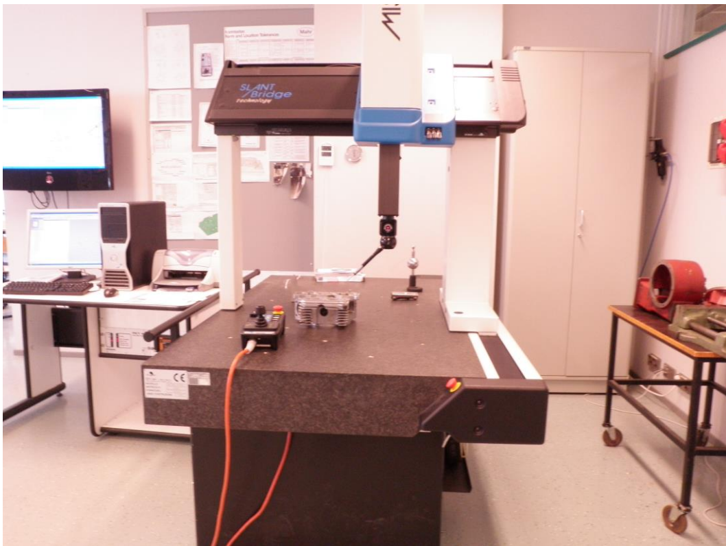
Kuva 7. Vaasan ammattikorkeakoulun Technobotnian koordinaattimittauskone.
