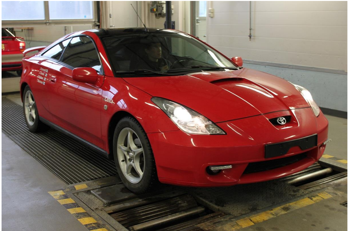
KUVA 12. eCelican iskunvaimennintestauslaitteiston päällä
