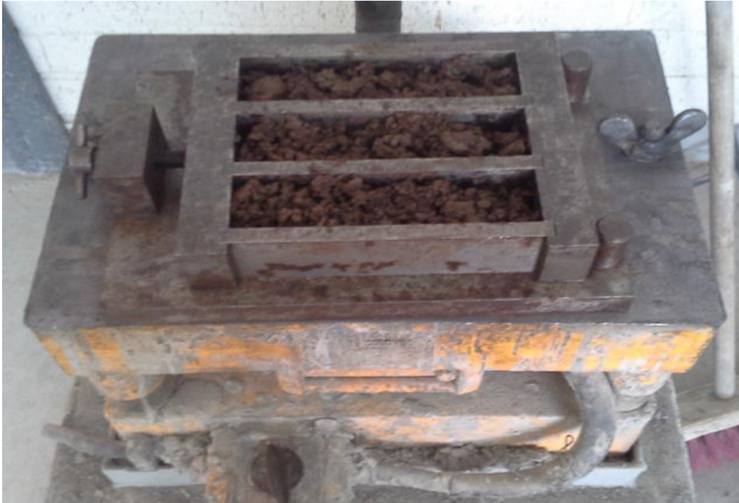
KUVA 3. Tärypöytää käytettiin massan tiivistämisessä
