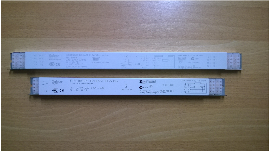
Kuva 10. Elektroniset liitäntälaitteet; yläpuolella uusi EL 2x49 iDim Active, alapuolella EL 2x49s.
