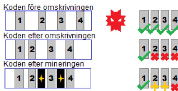
Figur 2. Genom att först skriva om binärkoden och sedan lägga minor där den ursprungliga gadget fanns kommer attackeraren att trigga minor och misslyckas med sin attack
