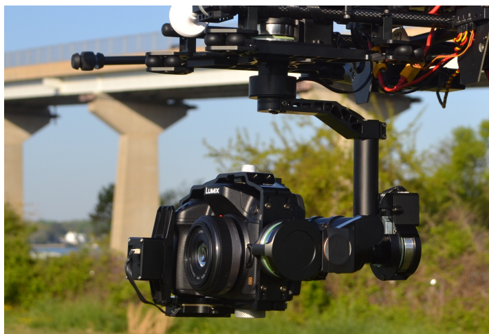
Figur 13. En 3-axlad Zenmuse Z15 kamera gimbal med servo drivsystem. (Jenny 2014)
