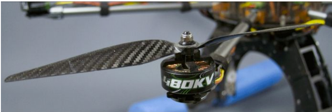
Figur 4. En kolfiberpropeller fäst på en borstlös likströmsmotor med 480KV. (Audronis 2014)
