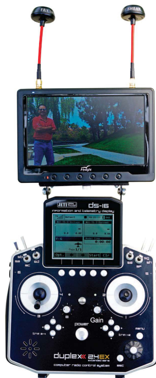
Figur 15. Ett exempel på hur ett FPV system med klöverantennor kan vara uppsatt. (RotorDrone 2014)
