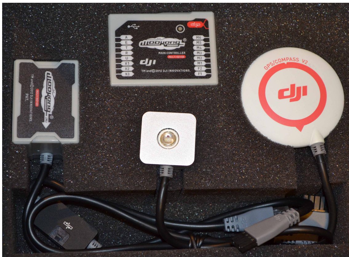
Figur 7. Till vänster är en IMU, uppe en MC, höger en GPS/kompass och i mitten en LED som visar i vilket flygläge FC:n är. (Jenny 2014)
