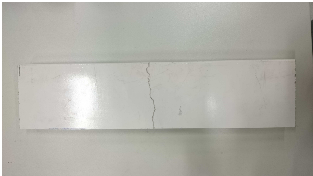
KUVA 14. Testikappale kolmipistetaivutuksen jälkeen ylhäältä päin
