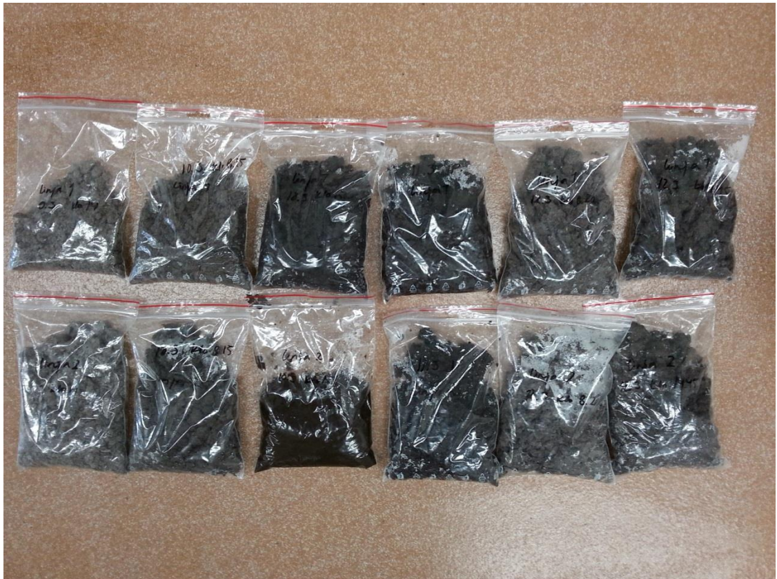
KUVA 27. Koeajon kuivattuja lietteitä aikajärjestyksessä, ylärivissä 1. ruuvi ja alarivissä 2. ruuvi (Elina Nousiainen 2015-3-13)
