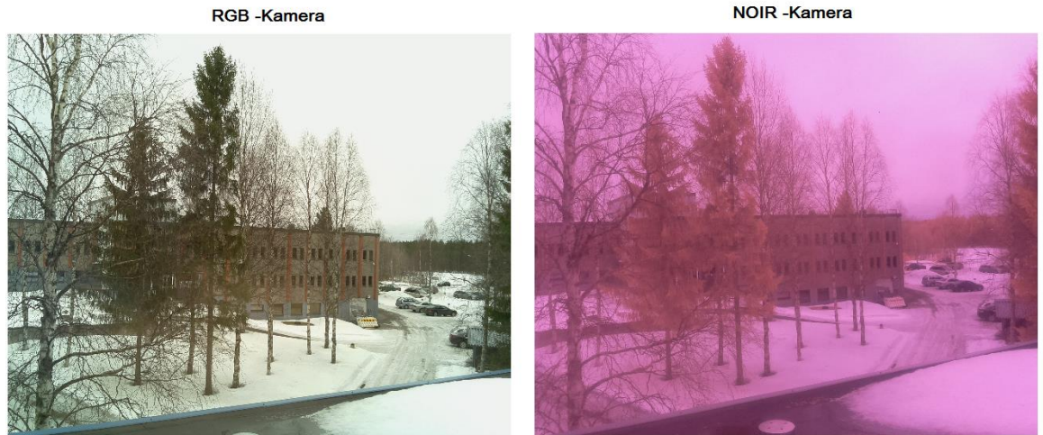
Kuva 20. RPI kuvantamis- ja mittajärjestelmän kuvaotokset normaalilla RGB- ja NOIR-kameralla lehtivihreän havaitsemiseksi. ID 21. ja 22. taulukko 3.
