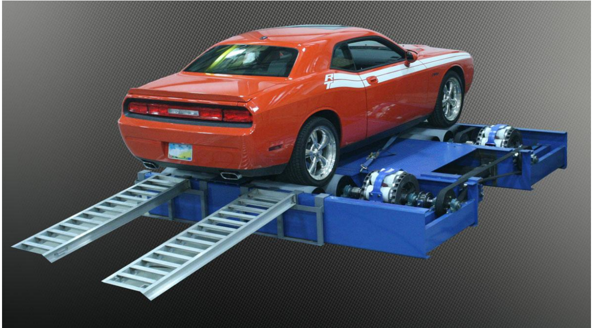
Kuvio 20. Ajourullien sekä pyörrevirtajarrujen linkityksellä varustettu dynamometri. (Mustang dynamometer 2014.)
