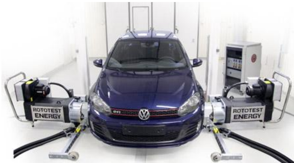
Kuvio 22. Rototestin sähköinen dynamometri. (Rototest 2014.)
