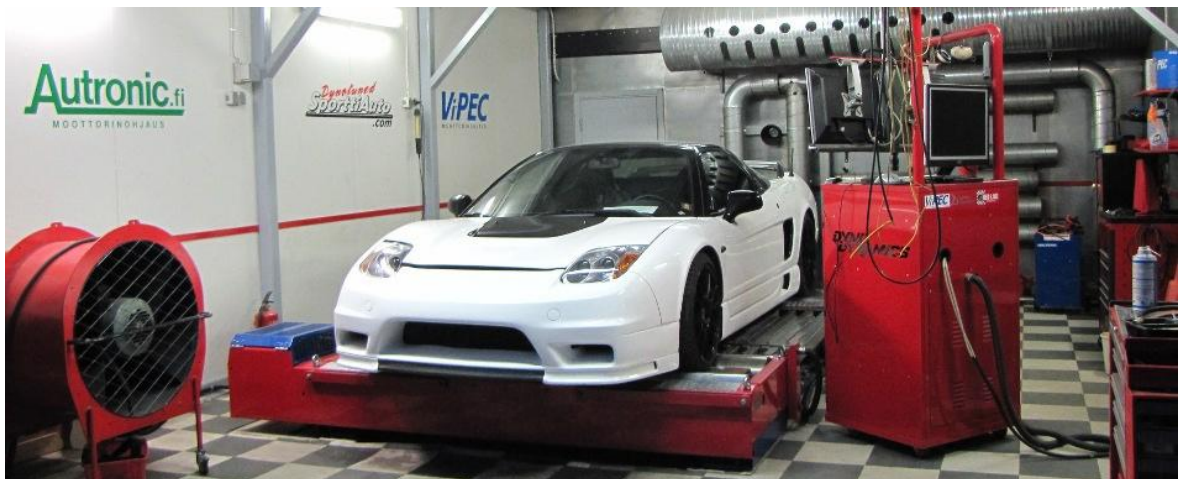
Kuvio 25. Sporttiauton pinta-asennettu alustadynamometri. (Sporttiauto 2014.)
