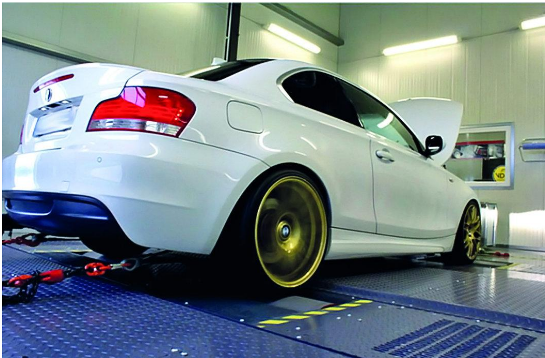
Kuvio 27. Ajoneuvo kiinnitettynä MRS500-alustadynamometriin. (Maha 2014.)
