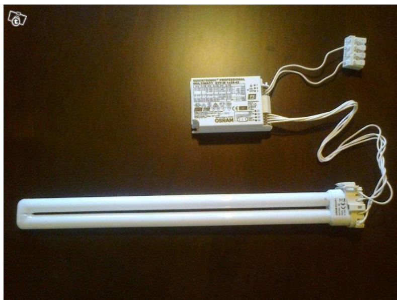
Kuvio 9. Pienoisloistelamppu ja elektroninen liitântälaite.
