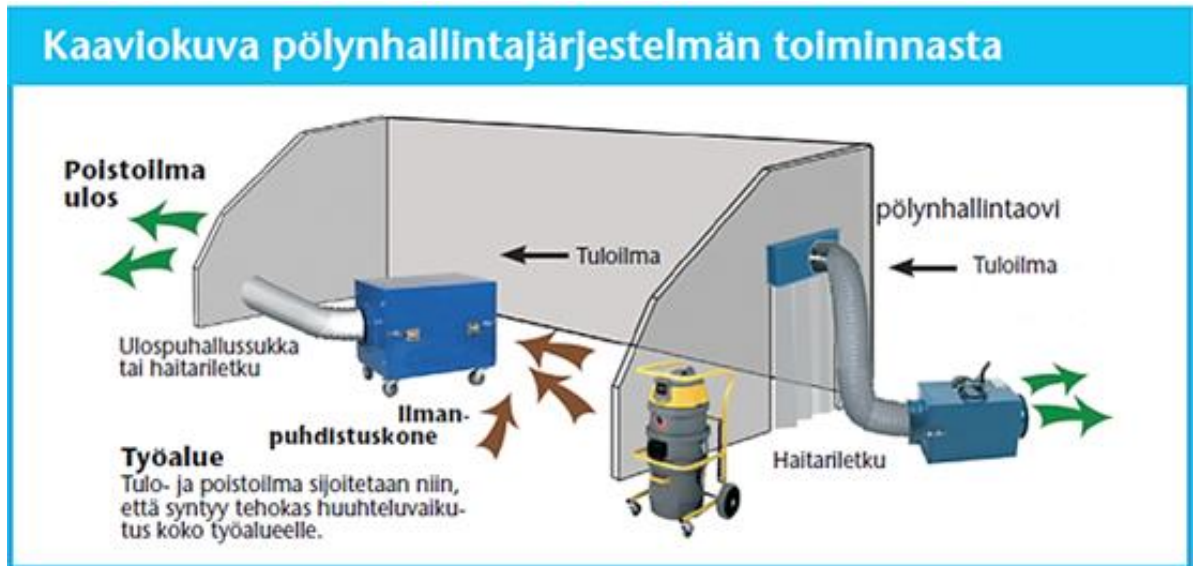
Kuva 8. Esimerkkitalanne alipaineistetusta tilasta. [8.]
