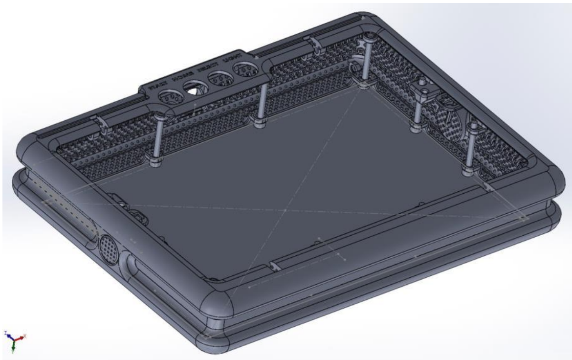
KUVA 24. Peliohjaimen kuoren keskiosan raita ja kannen lukitusmekanismi(Sievänen 2015-03-04.)
