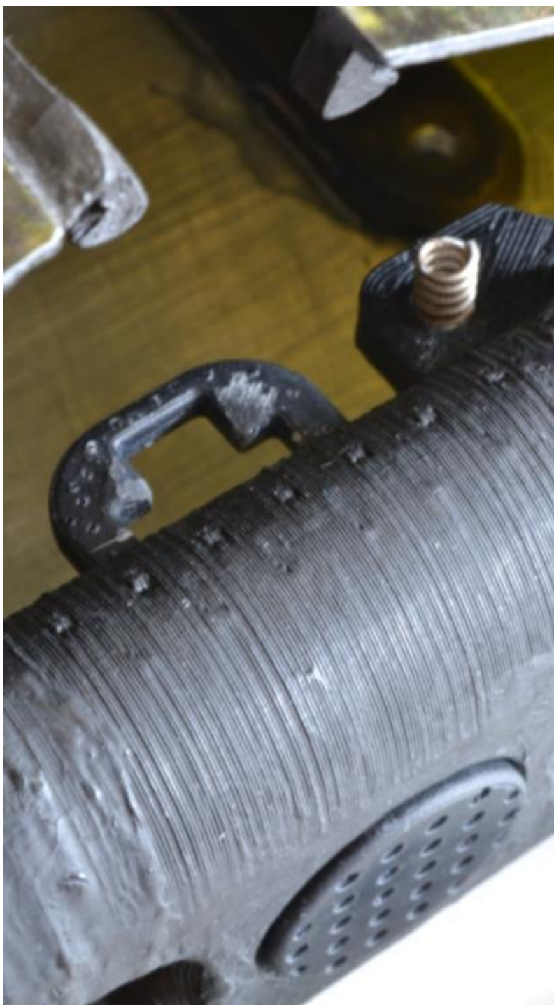
KUVA 40. Prototyypin kansien lukitusmekanismi (Sievänen 2015-05-01.)
