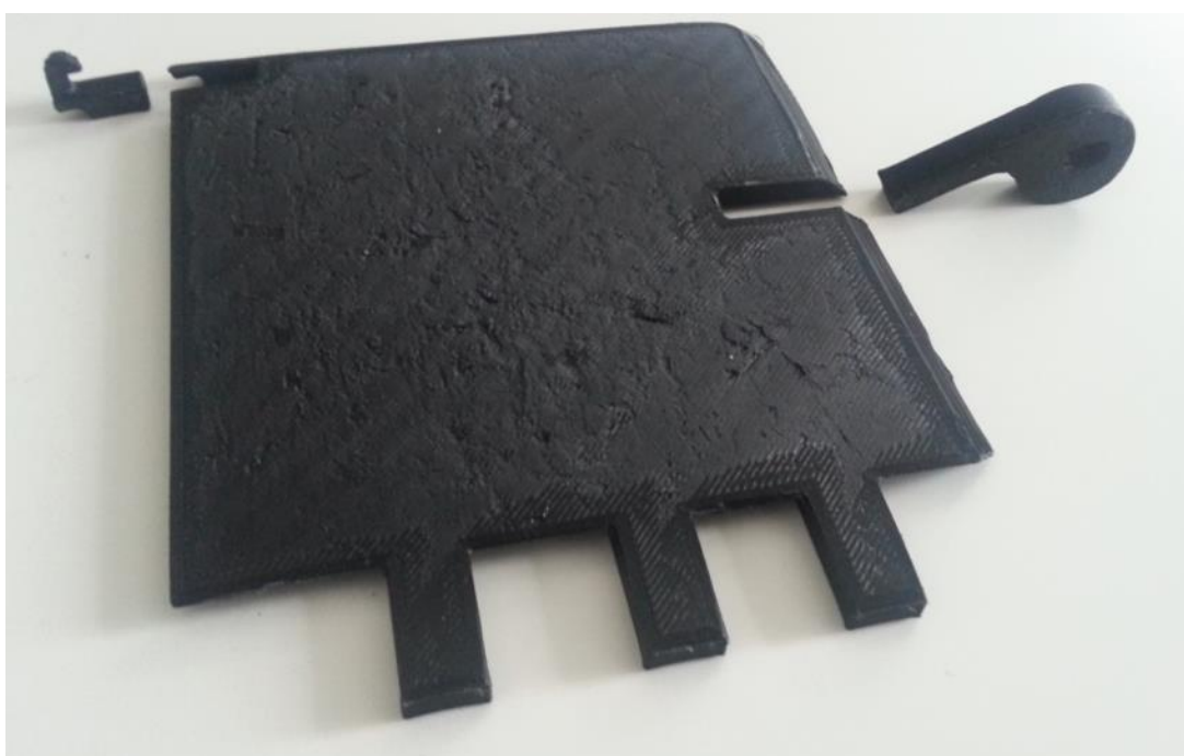
KUVA 32. 3D-tulostettuja kannen palasia (Sievänen 2015-04-10.)
