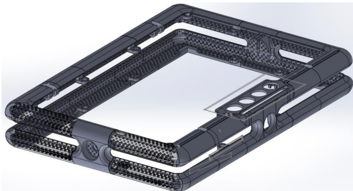
KUVA 31. Kuoren mallinnus, jonka Mikko Hoffren jakoi tulostettaviin palasiin (Sievänen 2015-04-15.)
