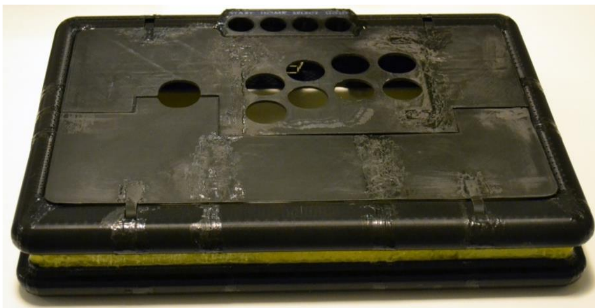
KUVA 36. Modulaarisen arcade-peliohjaimen kotelo kokonaisuudessaan ennen maalausta (Sievänen 2015-04-21.)
