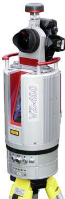
Kuva 10. Riegl VZ-400-laserkeilain varustettuna järjestelmäkameralla. [15]
