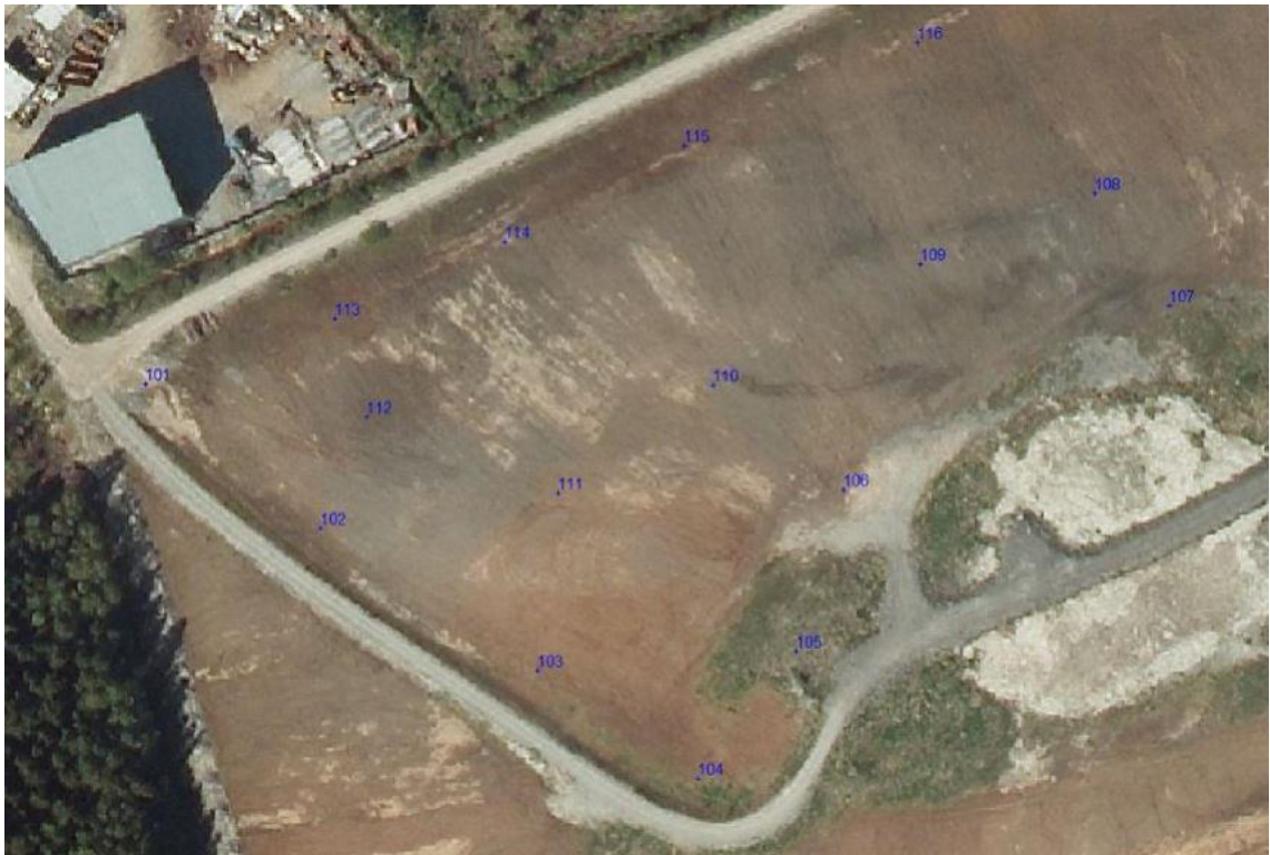
Kuva 6. Rakennettujen signaalien sijoittuminen ja numerointi kuvauskohteessa.
