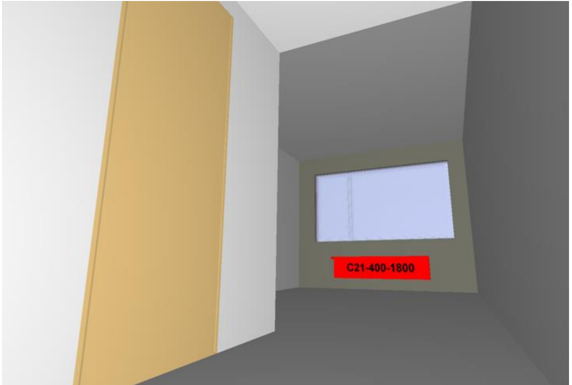
Kuva 19. Hotellihuoneen radiaattori mitoitustilanteessa 60/30 °C
