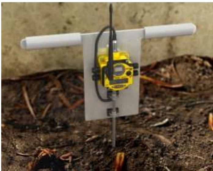
Bild 13: Banner Engineerings trådlösa temperaturmätare (bild tagen från www.bannerengineering.com )
