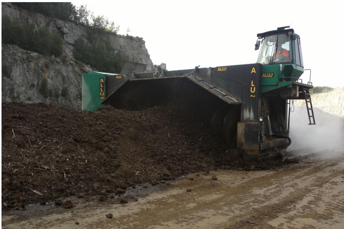
Bild 8: Allu AH38H kompostvändare.
