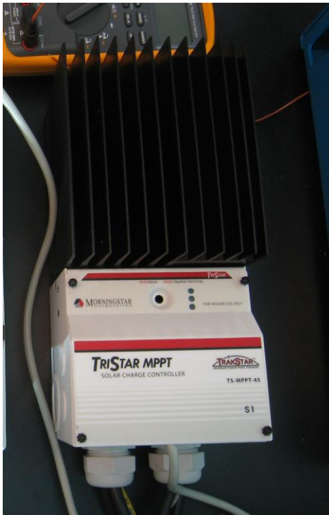
KUVA 3. TriStar TS-MPPT-45 –lataussäädin
