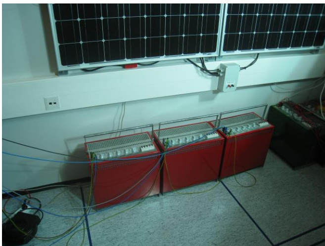
KUVA 13. Paneelien lämmittäminen vastuslaitteistoilla
