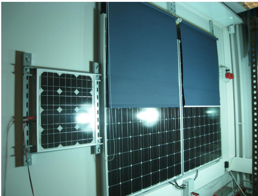
KUVA 15. Mittaustilanne, molemmat paneelit puoliksi varjostettuna
