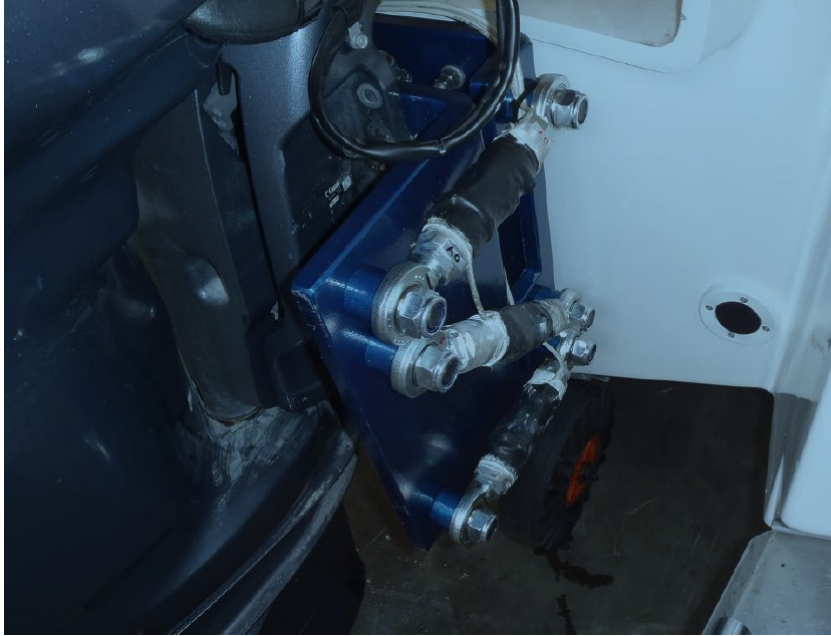
Kuva 22. Vetolaitteen kiinnityskohtaan sijoitetut mittaussauvat (VTT 2009)
