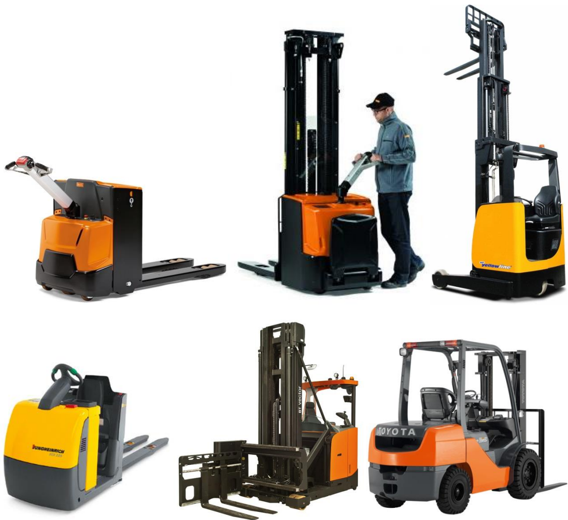
KUVA 7. Ylhäältä alas ja vasemmalta oikealle lueteltuna, lavansiirtotrukki, pinoamistrukki, työntömastotrukki, keräilytrukki, kapeakäytävätrukki ja vastapainotrukki
