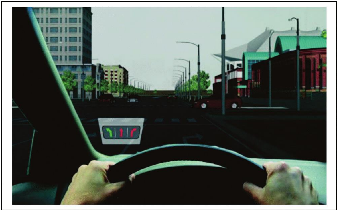
KUVIO 5. Virtuaaliset liikennevalot heijastettuna tuulilasiin (Olaverri-Monreal ym. 2012.)
