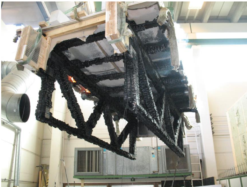
KUVA 22. Hiiltynyt ristikko polttokokeen jälkeen
