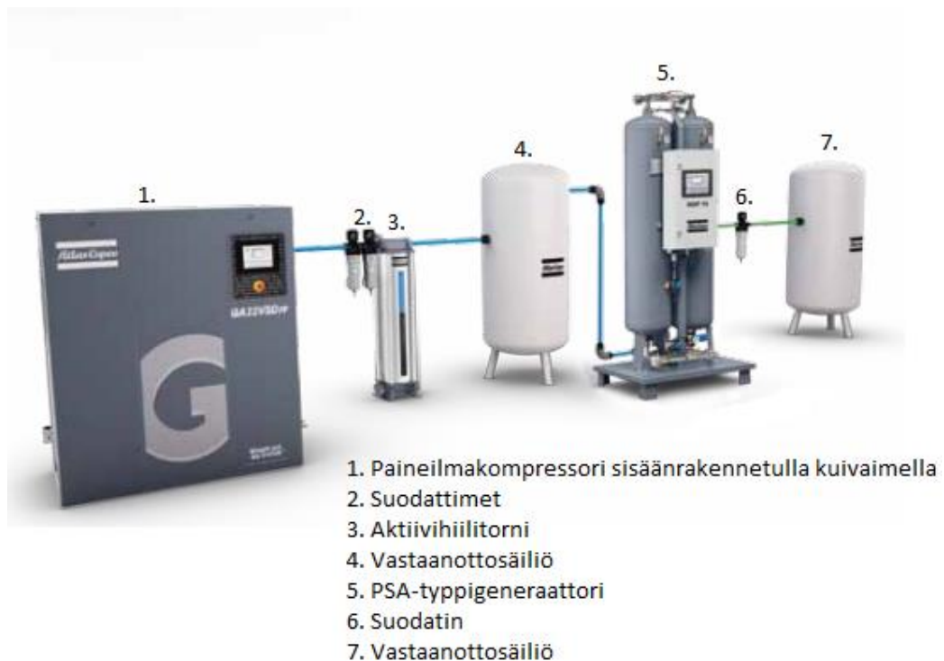
Kuvio 5. Tyypillinen PSA-järjestelmä (Atlas Copco, [Viitattu 23.2.2015]).
