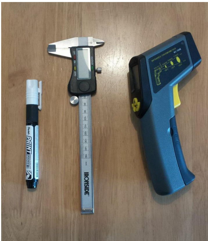
Kuva 9. Vasemmalta lukien mittauksessa käytetyt välineet: rengaskynä, digitaalinen työntömitta ja infrapunalämpömittari.
