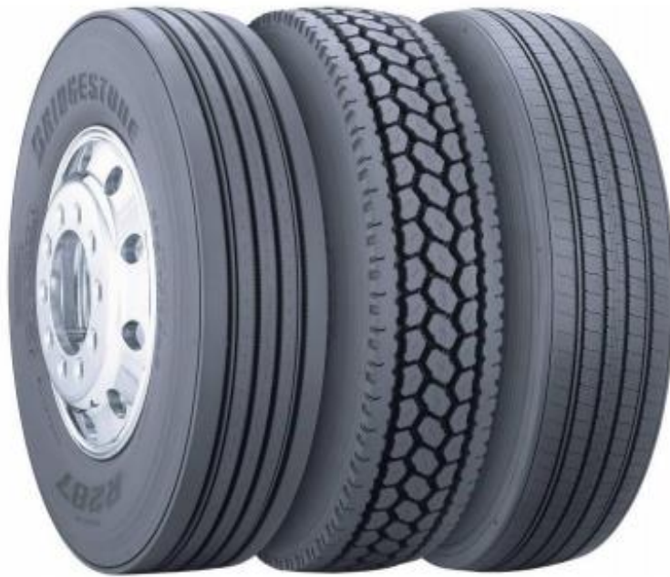
Kuva 1. Eri akseleille tarkoitetun renkaan kulutuspinnan kuviointi. Vasemmalta lukien ohjaavalle, vetävälle ja rullaavalle akselille suunnitellut renkaat (Naskali 2010, 16).
