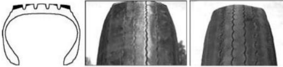
Kuva 4. Alipaineinen rengas kuluu voimakkaammin olka-alueilta suhteessa kantamaansa kuormaan (Naskali 2010, 83).
