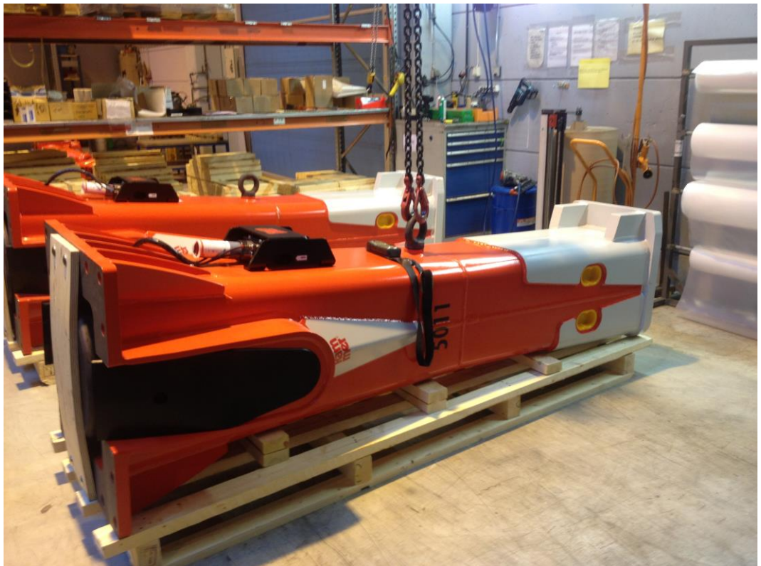
Kuva 8. Kuljetusrasituksia vastaan valmistettu puulava
