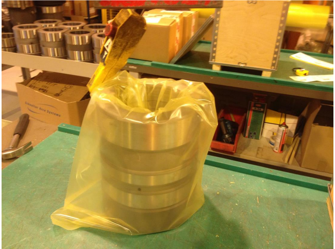
Kuva 10. Suojakalvolla korroosiosuojattu varaosa
