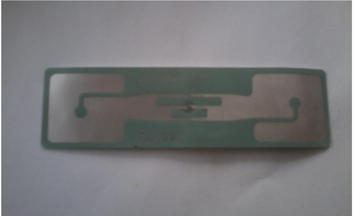
Kuva 6. Toisenmallinen laitteeseen liimattava tarratunniste
