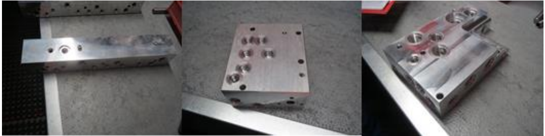
Kuvio 5 Yhdet variaatiot koneistetuista yhdys-, vaihteisto- ja voitelulaatoista
