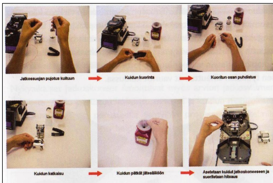
KUVA 41 Hitsaamisen vaiheet (Sähköinfo Oy 2009, 47.)
