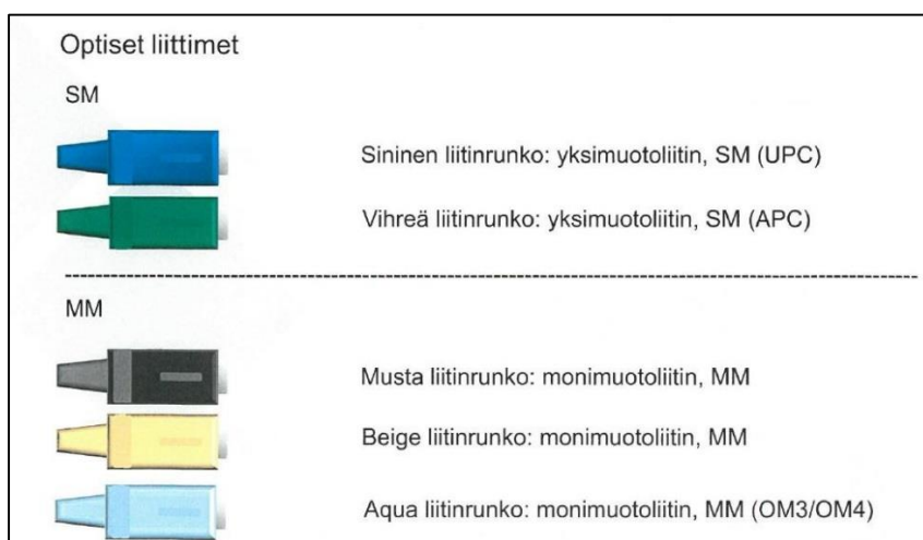
KUVA 23 Optiset liittimet (Sähköinfo Oy 2014.)
