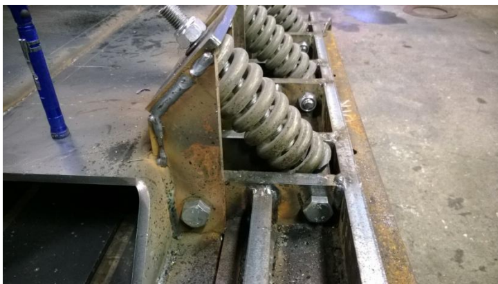
KUVA 15. Rakennekuva terälevyn ja perussiiven liitoksesta. Pekka Ryhänen 10.6.2014.
