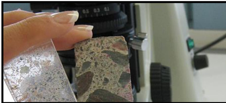
Kuva 2. Kuvassa on ohuthie ja pintahie. (Ositum Oy)
