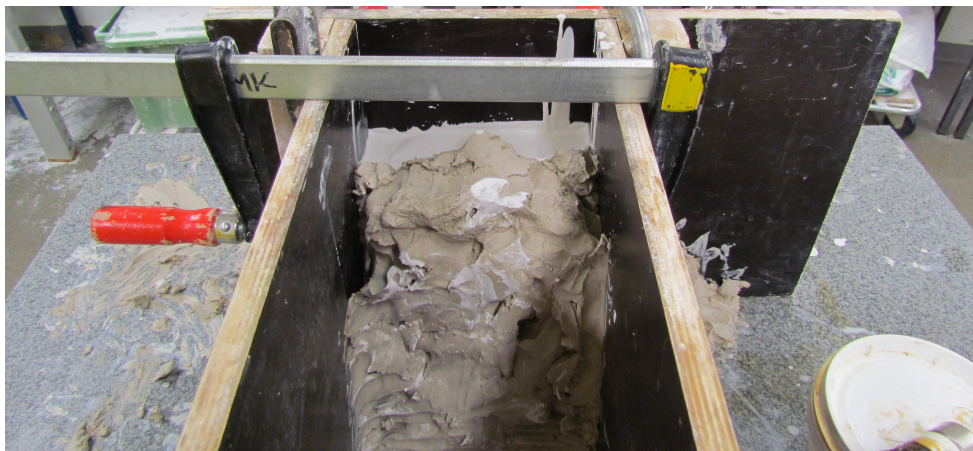
Kuva 41. Savipeti ja takaseinän valaminen kipsillä. Kuva: Inka Virolainen
