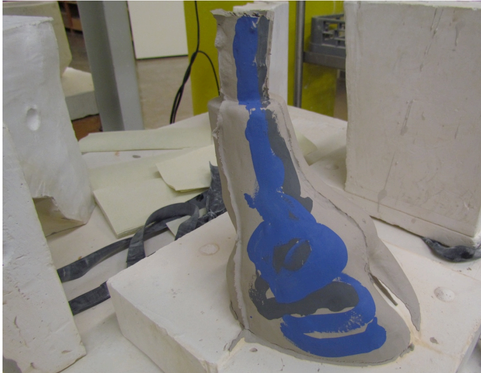
Kuva 48. Sivellintekniikkaa ja pidempi valukaula. Kuva: Inka Virolainen
