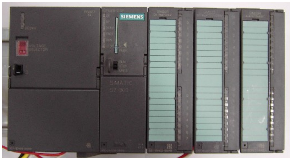
Kuva 7 Kuormituslaitteiston Siemens SIMATIC S7-300-sarjan PLC-moduulit
