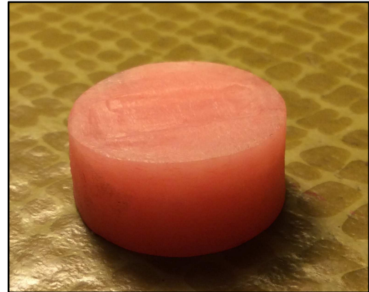
Kuva 9. Testialusta. Keskelle hiottu paikka kuidulle.
