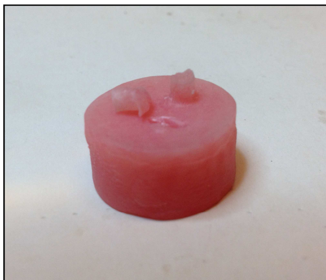
Kuva 14. Kohesiivisesti katkennut tappi. Kuvaus: Pasi Alander
