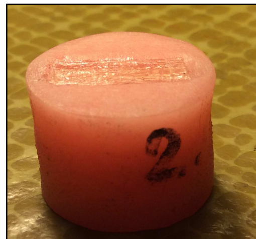
Kuva 10. Kuidutettu testialusta ennen pintakäsittelyä.
