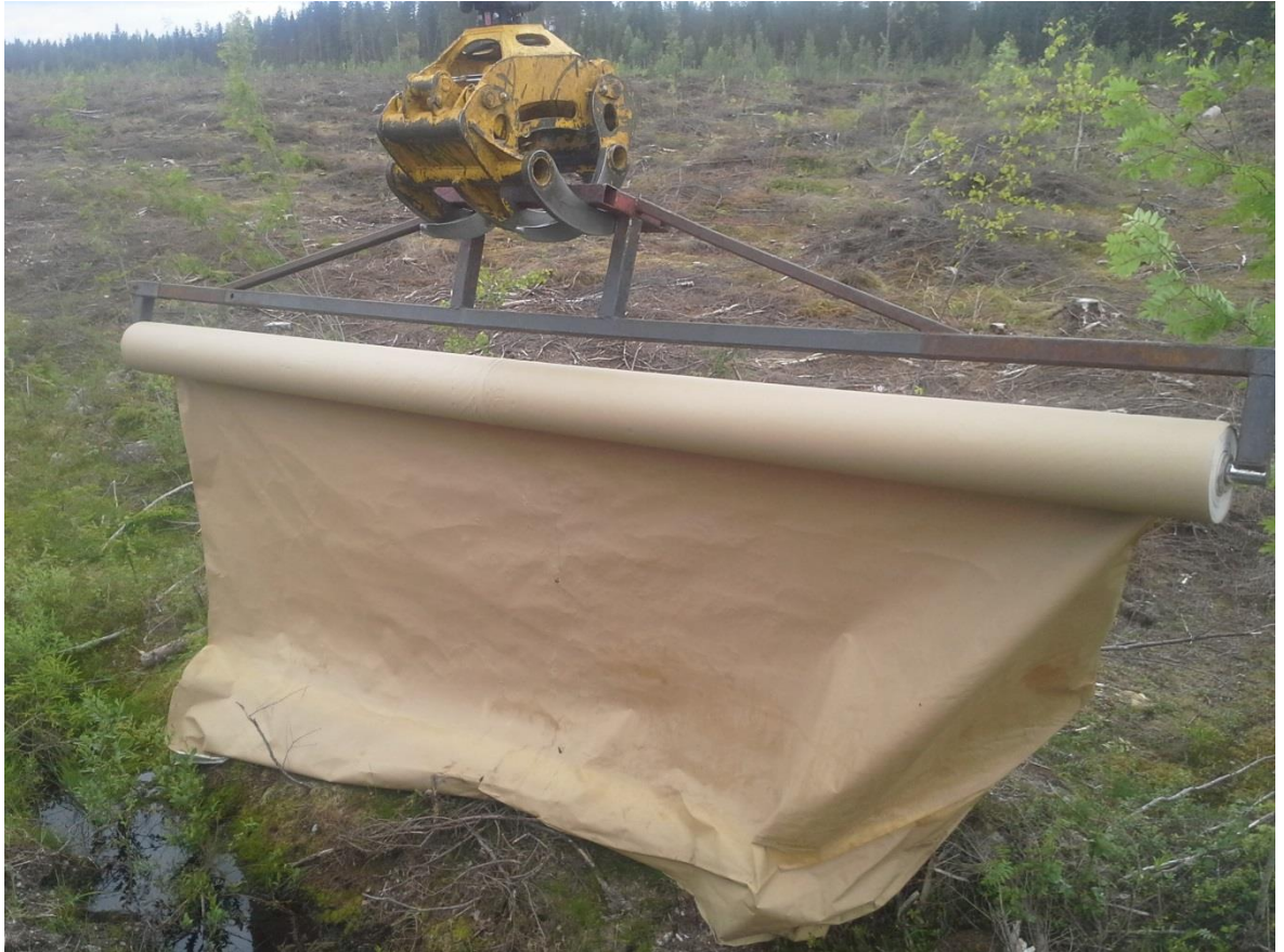
Kuva 7. Peittäminen tapahtuu kourassa riiputettavalla rullatelineellä.
