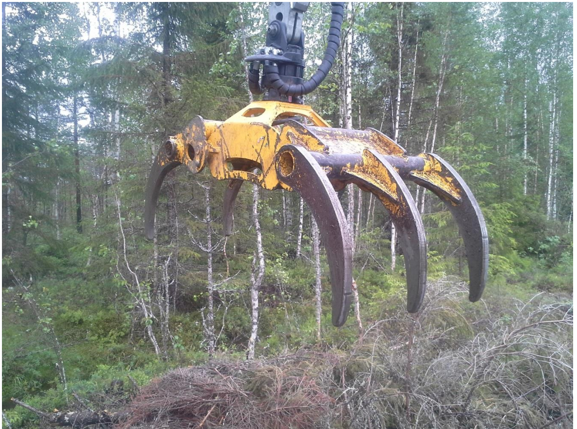
Kuva 6. Hakkuutähteiden ajoon soveltuva koura.
