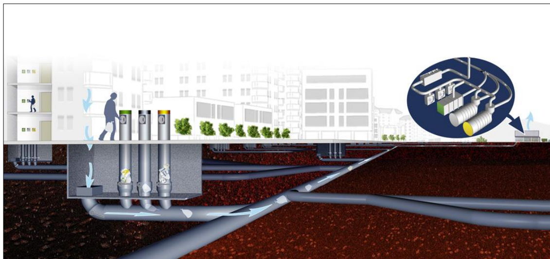
Kuva 2. Jäteputken toimintaperiaate (Sopsug 2015)
