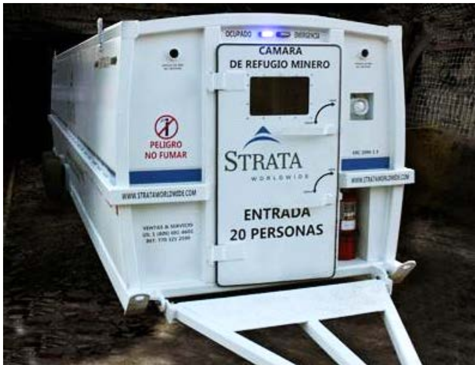
Kuva 8 Standardisuojatila varustettuna renkailla ja vetosilmukalla (Strata Worldwide 2015)
