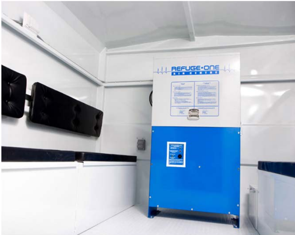
Kuva 6 Tommyknockerin pehmustetut penkit, joiden alla on säilytystilaa sekä Refuge One Air Center (Rana 2010)
