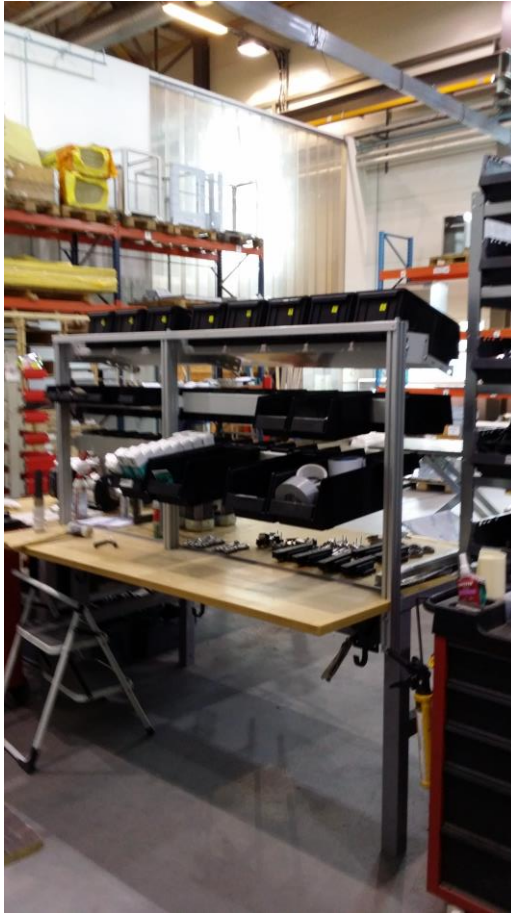
KUVA 14. Kuvassa vasemmalla mekaaninen osakokoonpano -työpiste ja oikealla sähköinen (Kuva: Lasse Pokela 2015)
