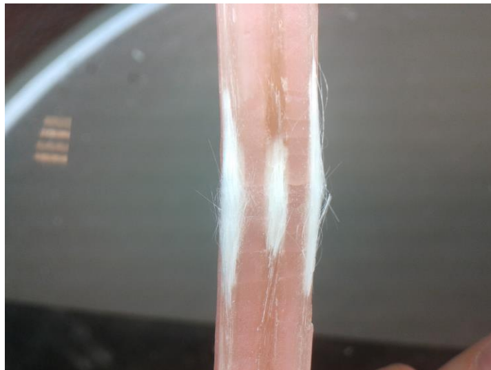
Kuvio 9. everStick-kuiduilla vahvistettu koekappale kolmepistetaivutuksen jälkeen.
