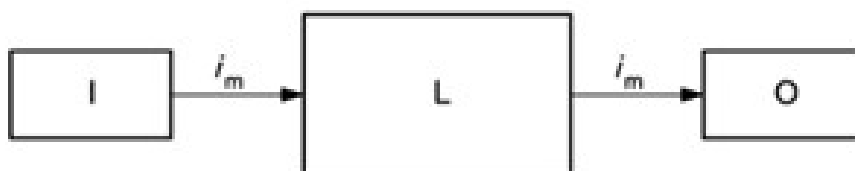
KUVA 2. Luokkaa 1 esittävä rakenne (SFS-EN ISO 13849-1 6.2.4)
