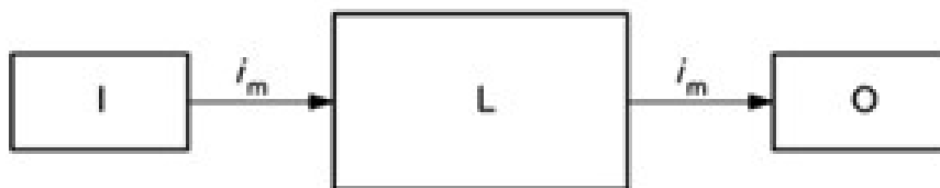
KUVA 1. Luokkaa B esittävä rakenne (SFS-EN ISO 13849-1 6.2.3)
