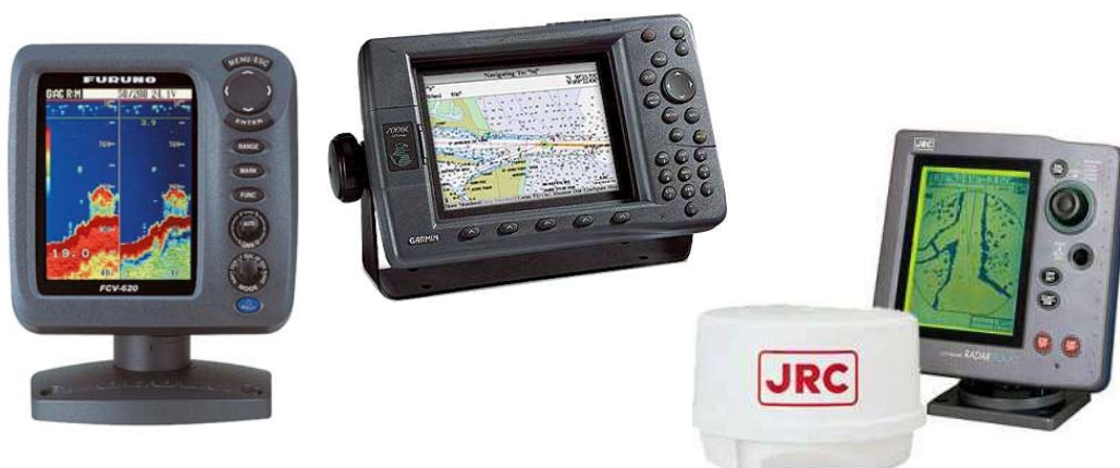
Kuva 17. Järjestelmävaihto B, kaikuluotain , karttaplotteri ja tutka
