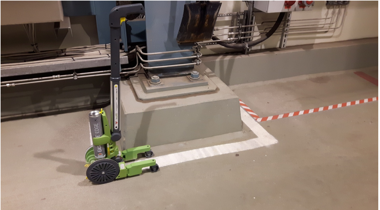
KUVA 7. Rocol Easyline -maalauslaite
