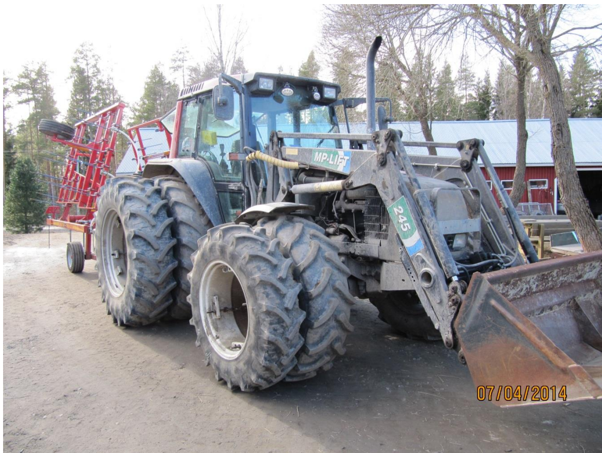
Kuva 18. Kylvötraktoriksi valikoitu Valtra 6750 varustettuna pariipyöriillä.
