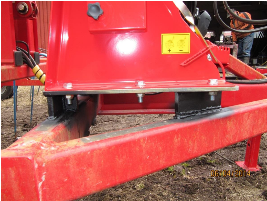
Kuva 9. Kylvölaite kiinnitettyä ja teline hitsattuna äkeen runkoon.
