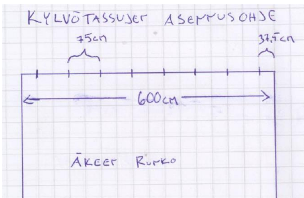
Kuva 5. Kylvötassujen asennuskohtien määrittäminen.
