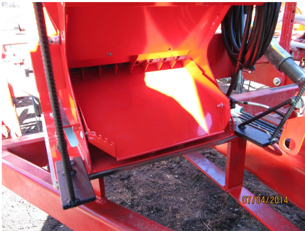
Kuva 19. Kylvölaite asetettuna kiertokoetiltaan. Alareunassa kangaspussin narujen hahlot.
