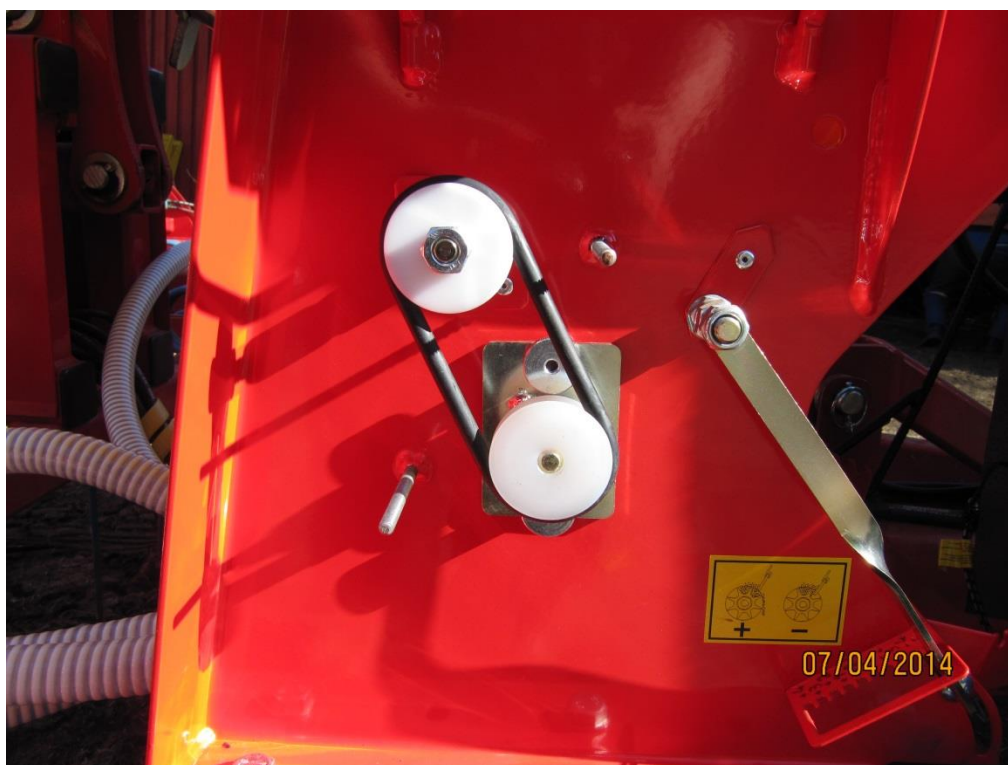
Kuva 17. Alempi rulla poistamalla päästiin käsiksi vaihdettavaan rihlaan.
