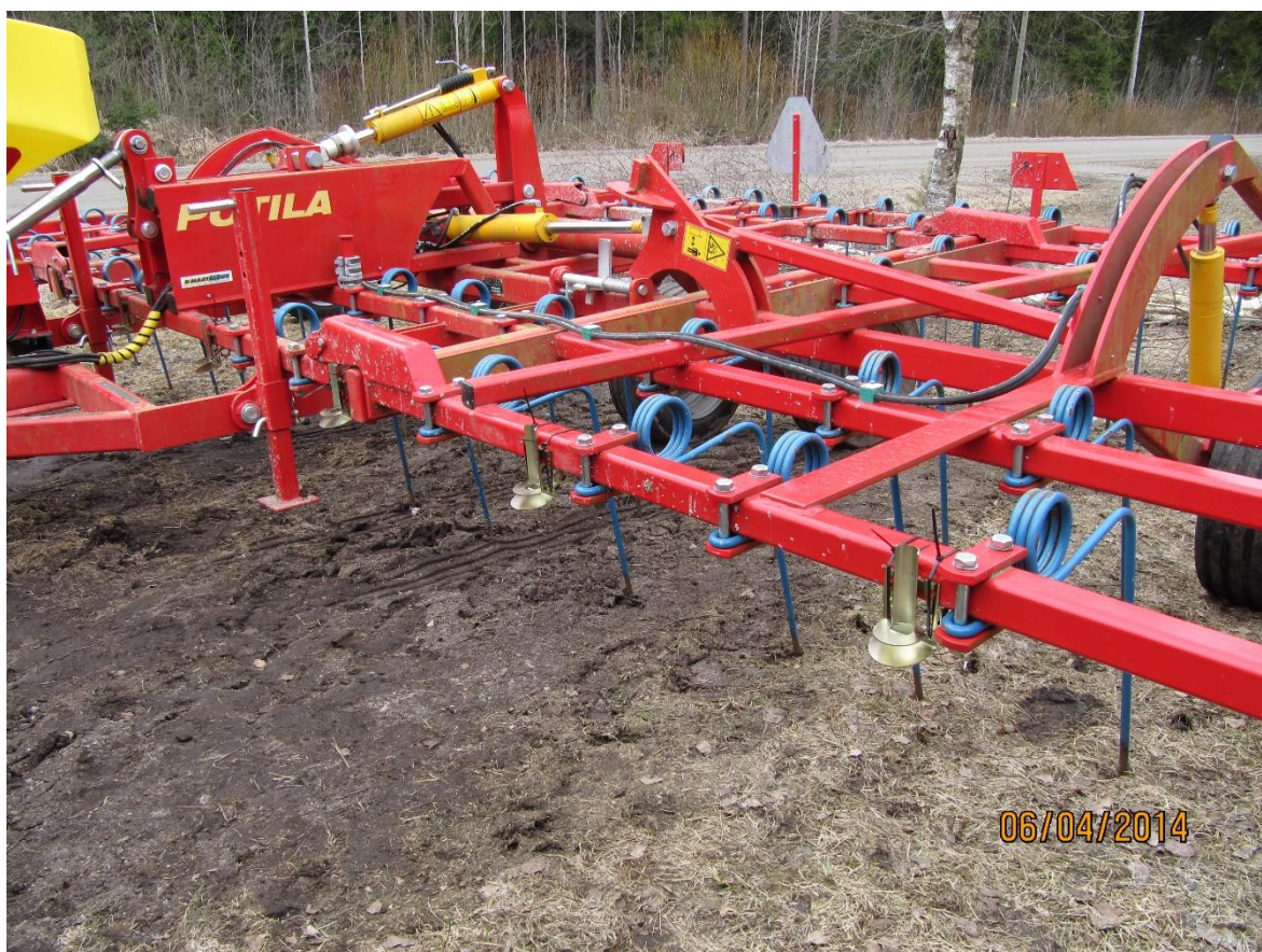
Kuva 11. Kylvötassujen asettelu nippusiteillä.
