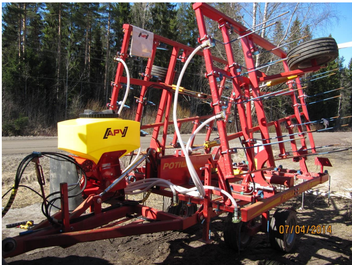
Kuva 21. Piensiemenkylvöes kalibroitu ja valmiina testiajoon.
