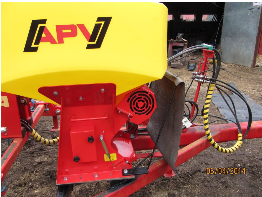
Kuva 10. Muovimatto telineineen asennettuna sähköpuhaltimen suojaiksi.
