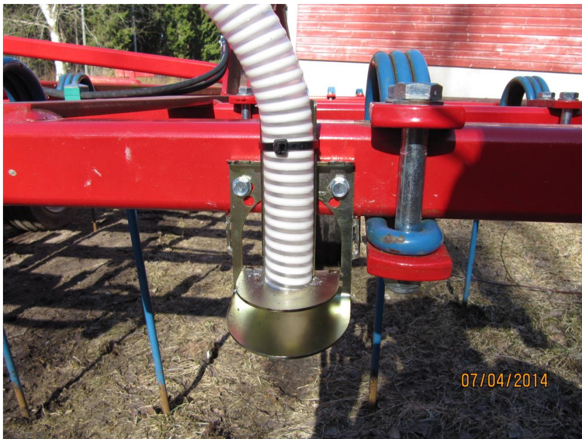
Kuva 12. Kylvötassu asennettuna lopulliseen kohtaansa.
