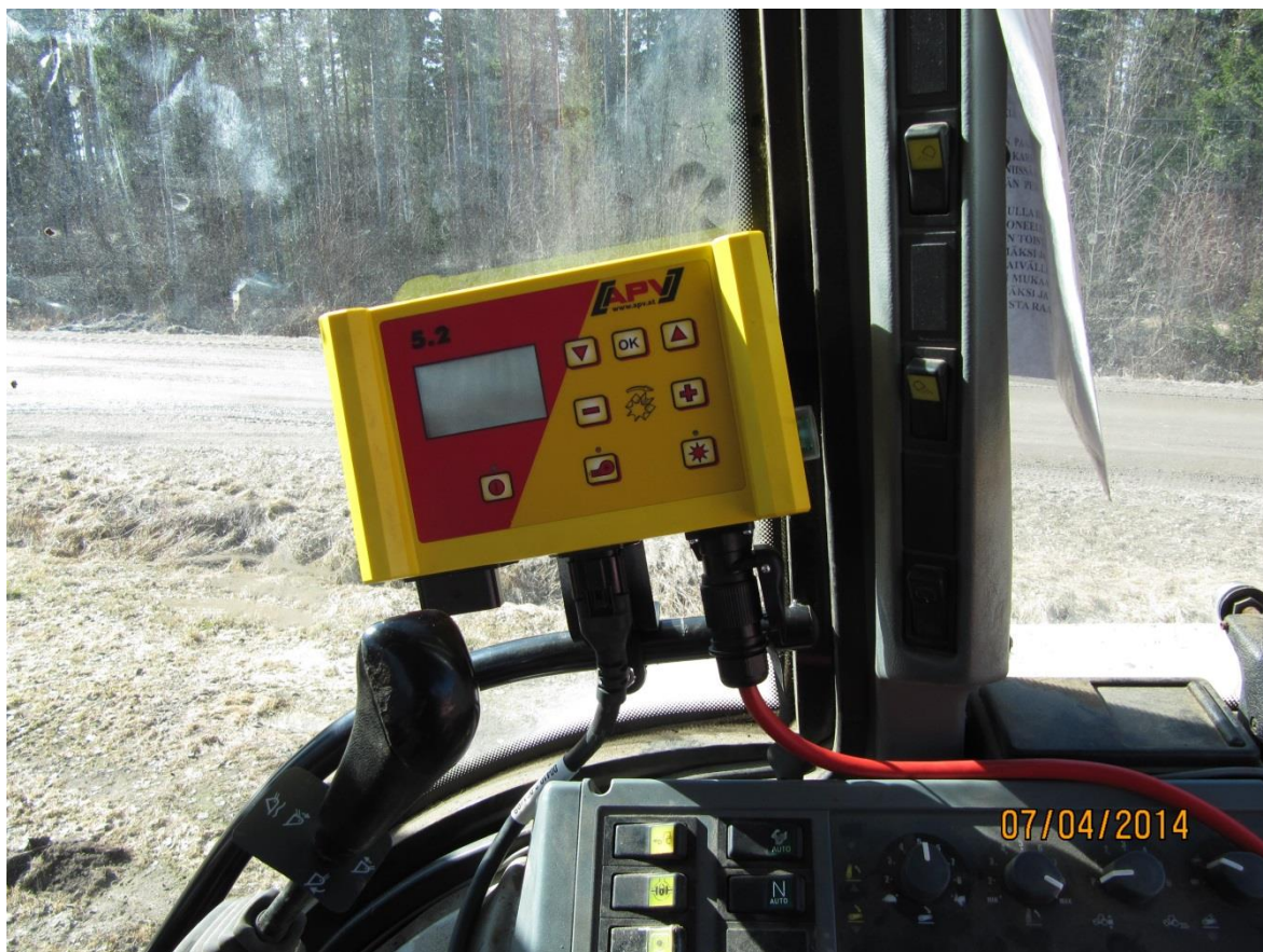
Kuva 15. Ohjainyksikkö asennettuna Valtran ohjaamoon.
