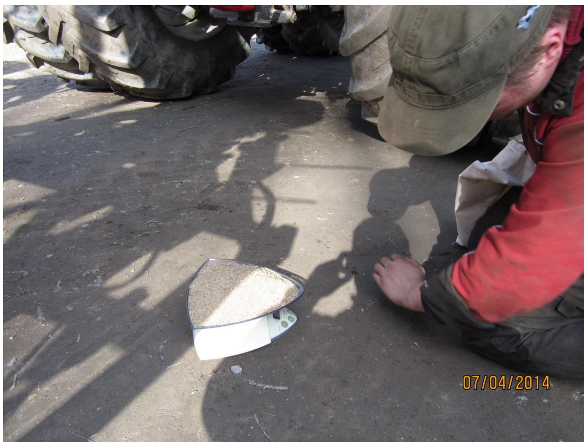
Kuva 20. Kiertokokeen punnitustulos tarkistettiin keittiöva'a'alla.
