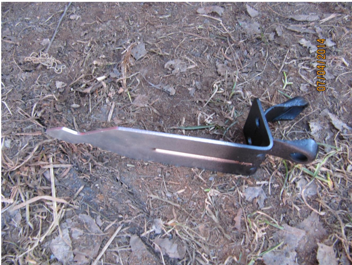
Kuva 14. Polkupyörän peilinrunko hitsattuna kiinni ohjainyksikön telineeseen.
