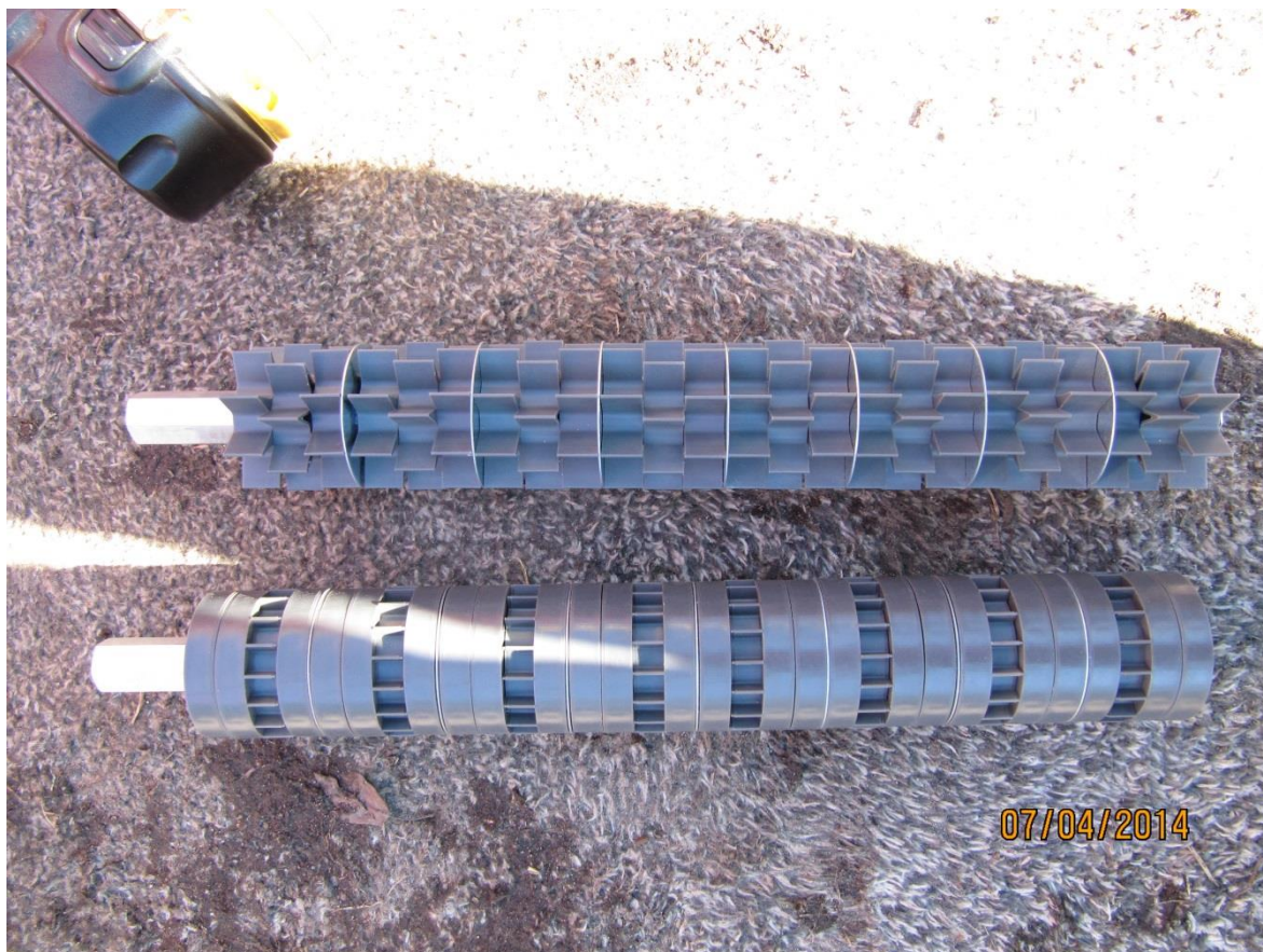
Kuva 16. Syöttörihla-akselit. Alempana piensiemensori.
