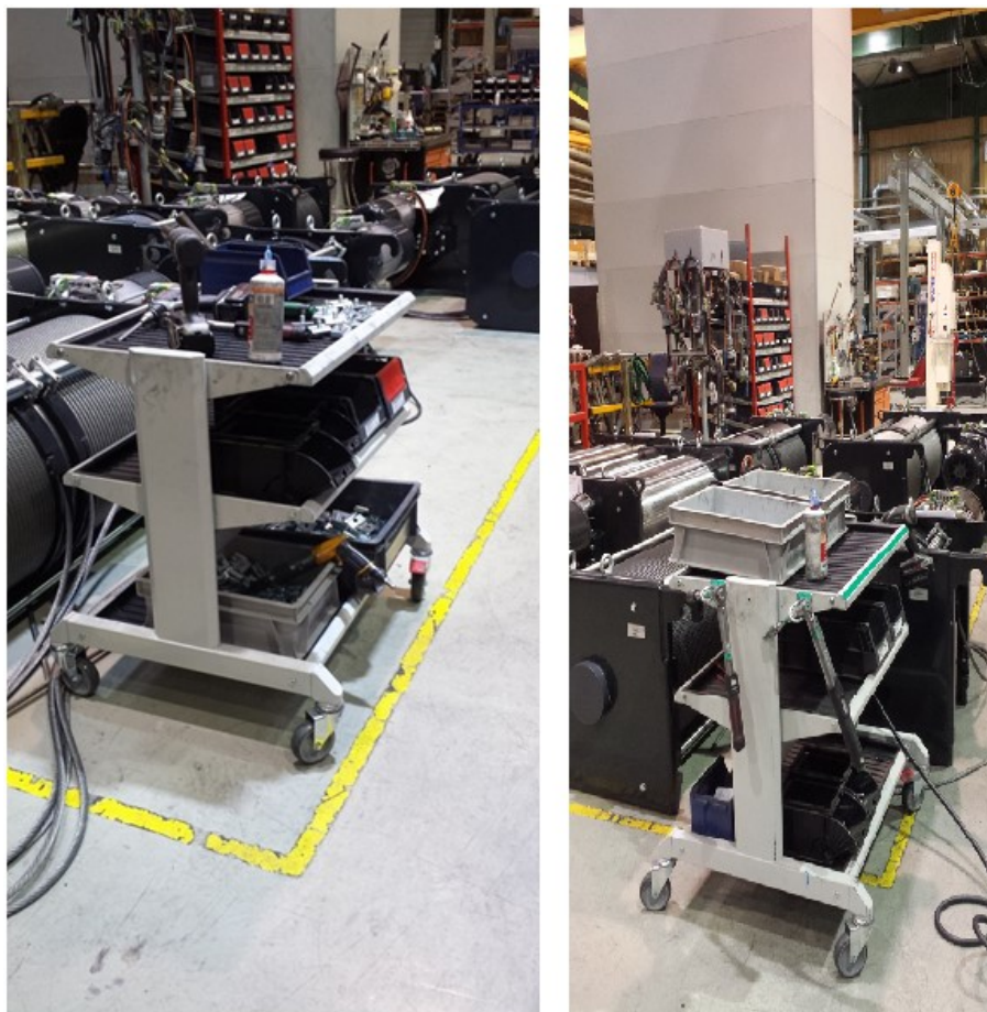
Kuva 18 HH2:n köysitys-solun työkaluvaunu ennen ja jälkeen 5S-projektin.
