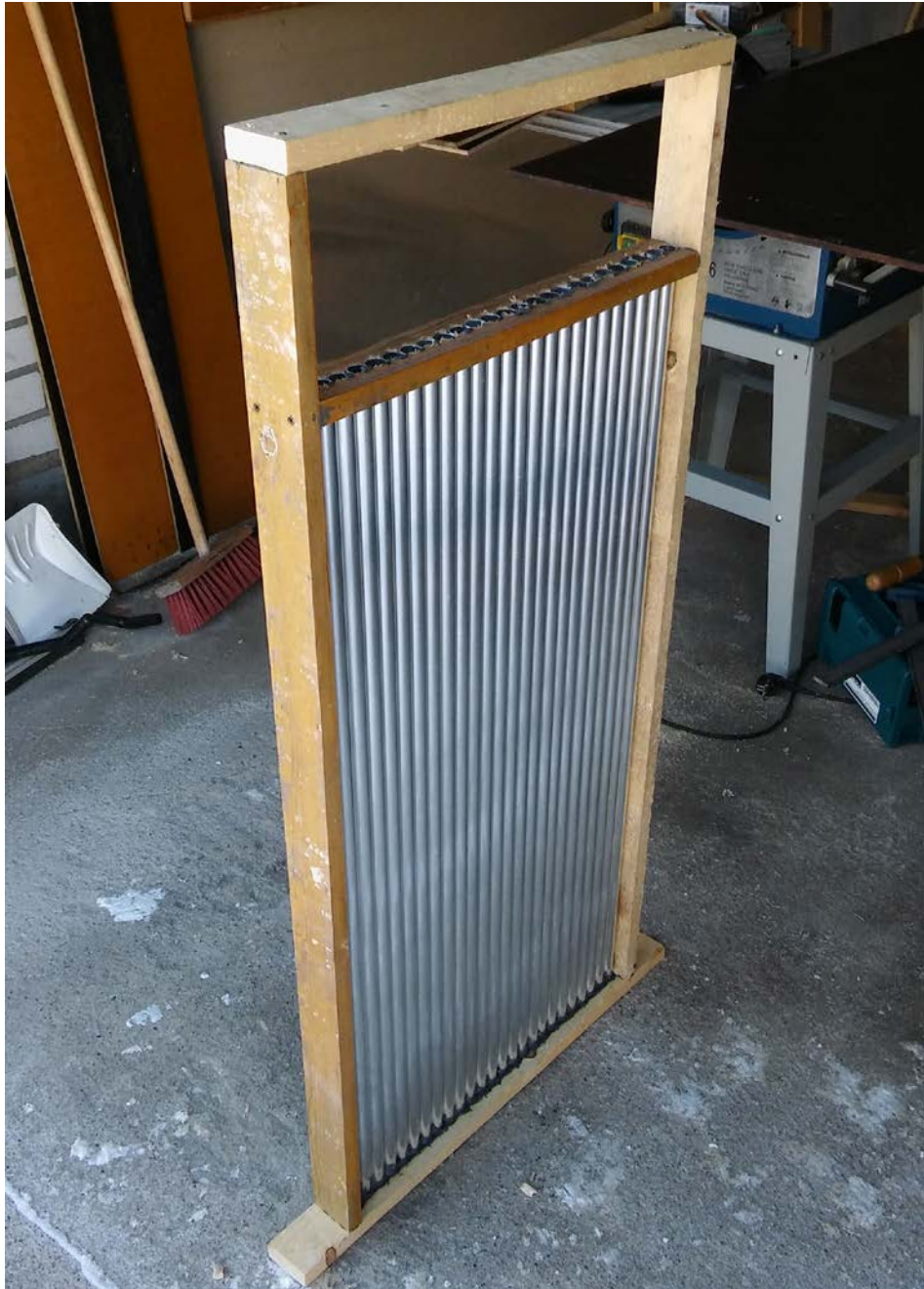
Kuva 15. Sisäseinien ja alumiiniputkiston alikokoonpano.
