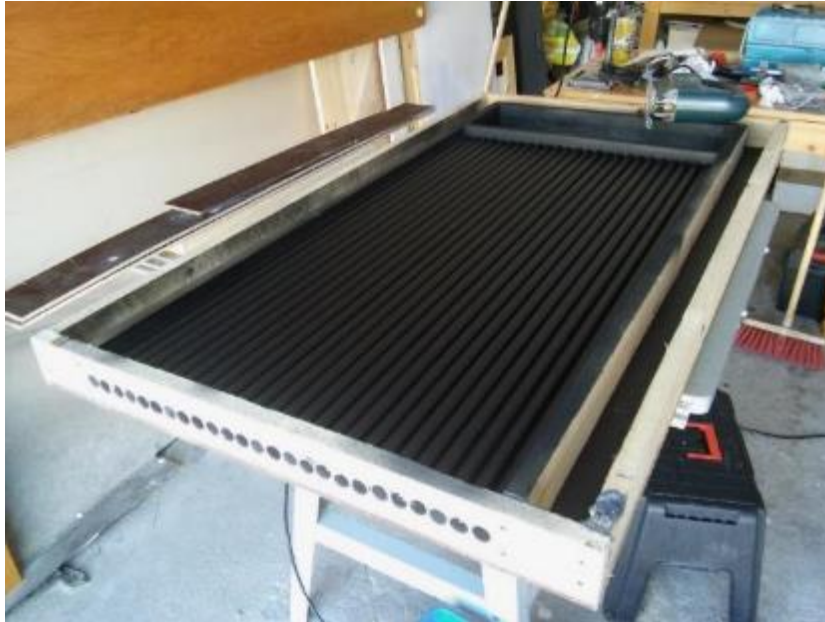
Kuva 17. Seinäalikokoonpano kiinnitettynä pohjalevyyn.
