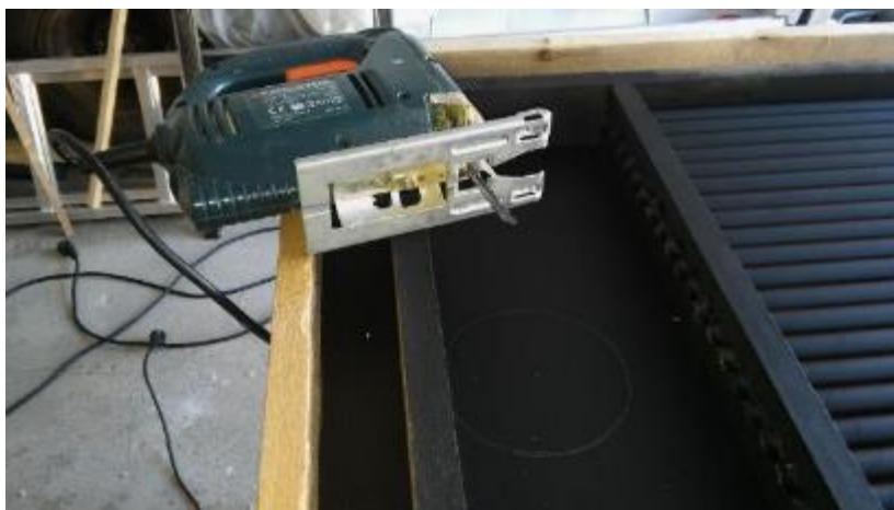
Kuva 18. Tuulettimen reikä tehtiin käyttäen reikäsahaa, kuviosahaa ja puukkoa.
