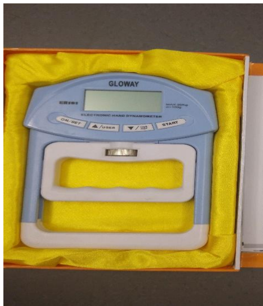
Kuva 9. Puristusvoimamittari Gloway model EH101 (Siv Aro kuva-arkisto)
