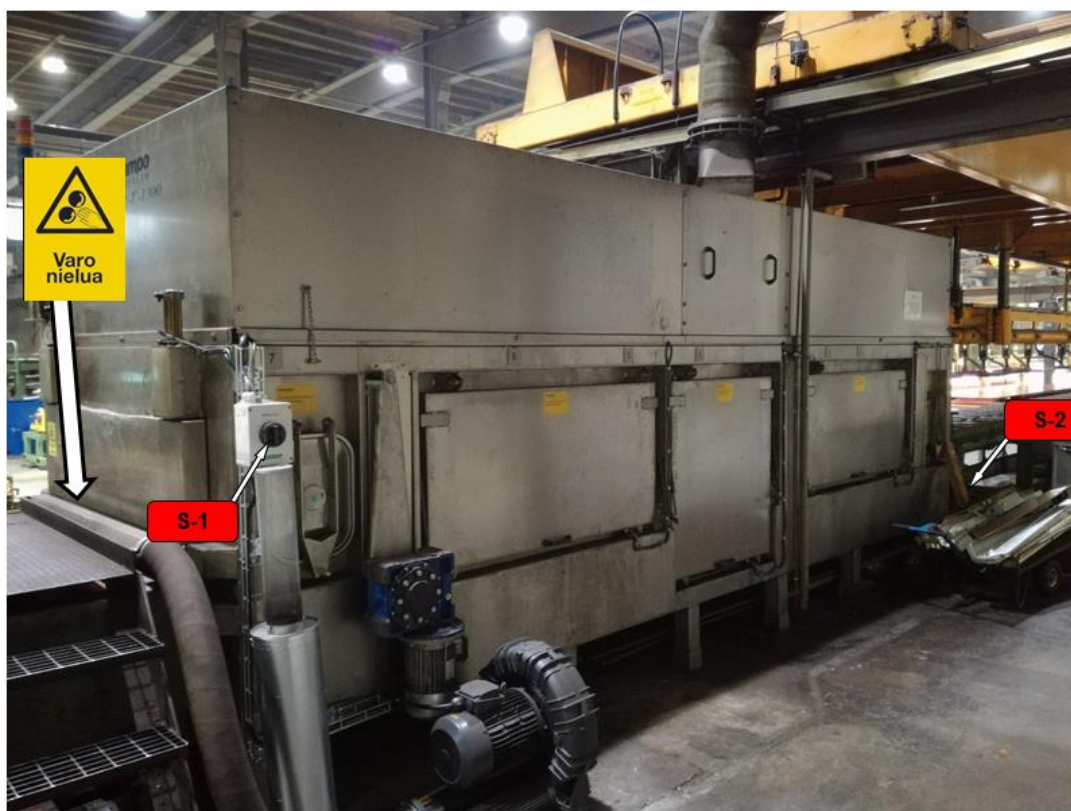
Kuva 13. Osa koneiden välittömistä riskinaiheuttajista merkittiin myös suoraan turvalukitusohjeistuksen kuvaan
