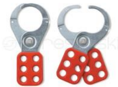
Kuva 9. Useamman henkilön turvalukitukseen soveltuvaan teräslukkohakaan voidaan kiinnittää useita riippulukkoja. Lukituksen voi poistaa vasta kun viimeinenkin riippulukko on irrotettu. (Lähde: Sareskosken www-sivut 2017)
