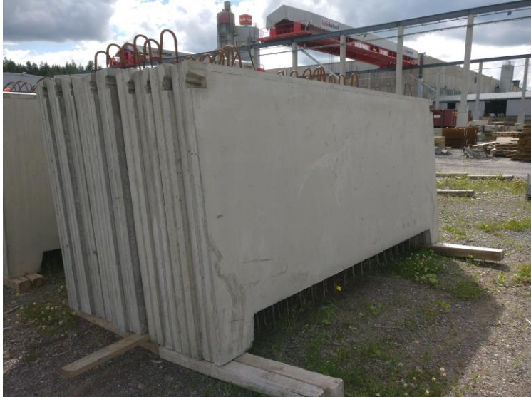
Kuva 6. Lujabetoni Oy:n valmistamia lietekanaelementtejä.
