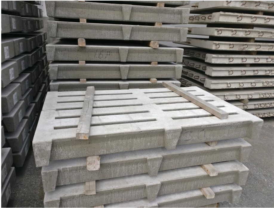
Kuva 8. Kaksi ritiläpalkkia vierekkäin varastoituna.
