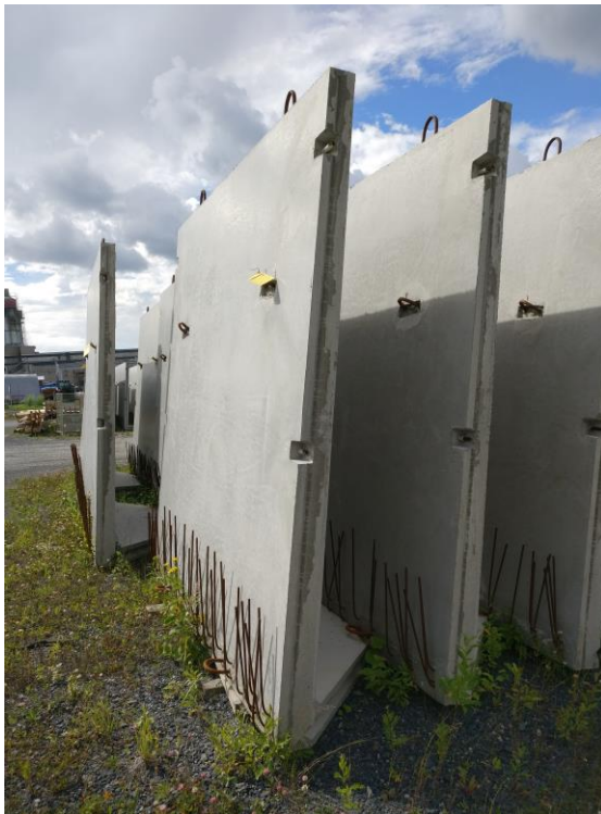
Kuva 11 Lujabetoni Oy:n valmistama laakasiiloelementti. Tartuntateräkset taivutetaan pohjavaluun.
