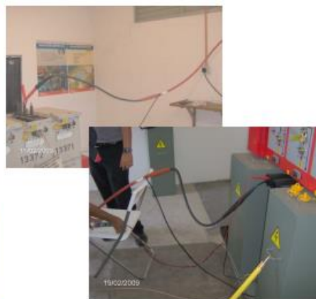
Kuva 15. Kytchentäkuva, kun tehdään DAC-mittausta. /9/
