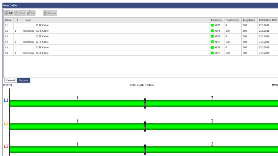
Kuva 23. Onnistunut kaapelien lisäys. /11/
