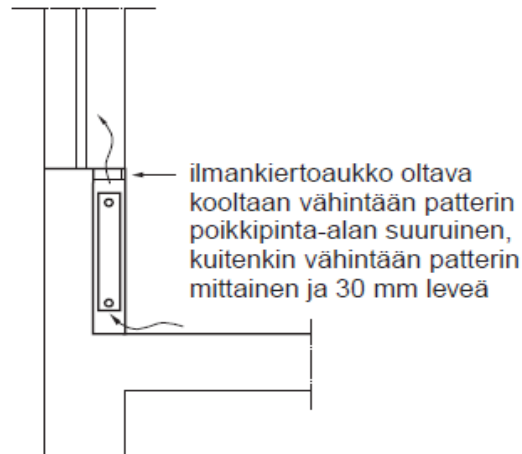
Kuva 6. Patterin asennus seinäsyvennykseen./10./
