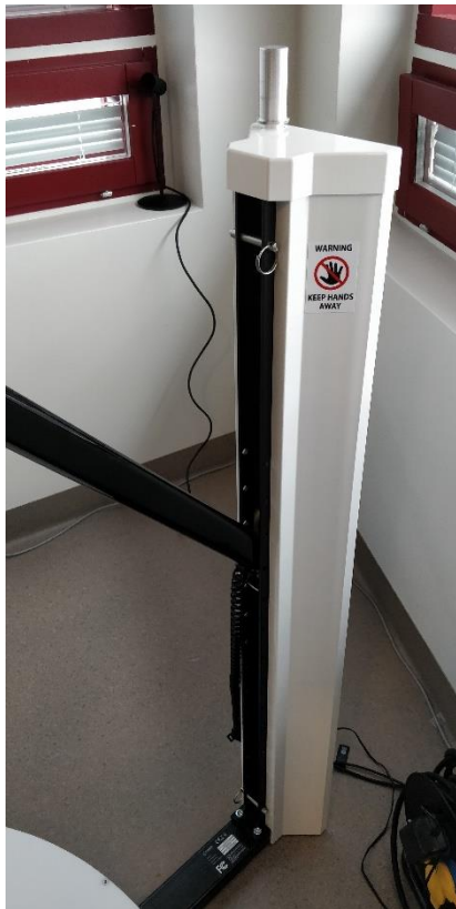
Kuva 3. Tukipylväs, jonka sisällä on korkeuden mittausanturit
