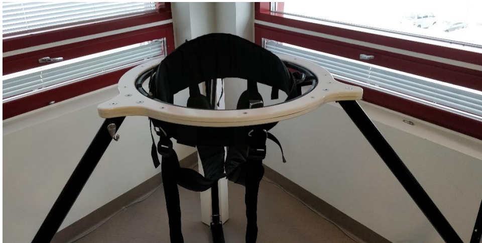
Kuva 4. Laitteen valjaat sekä pyörivä tukirengas (musta sisempi rengas)
