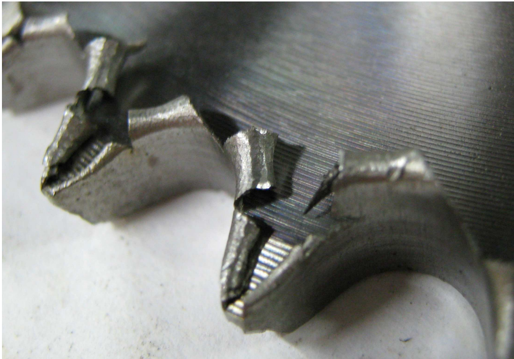
Kuva 6. Sitkeään materiaaliin muodostunut jäyste.
