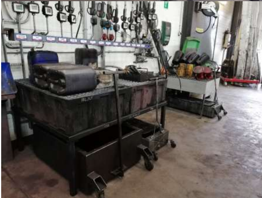
KUVA 10. Valuma-altaille valmistettiin kehikot ja näin tilaa saatiin lisää
